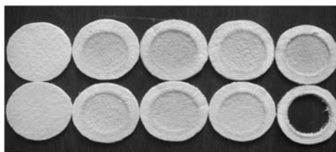
图5 水刺、针刺的耐磨性对比
